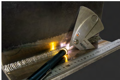
Begutachtungssituation einer Kehlnaht mit 4-Skalen-Schweißnahtlehre
